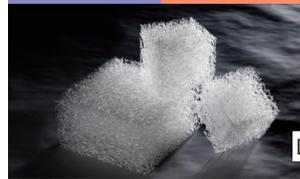
aircureは、独自開発のポリエステルエラストマー素材、ポリエチレン素材が複雑に絡み合った立体網状構造体の高弾性・高反発中材を使用しています。
